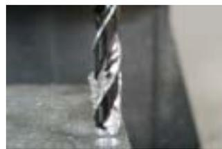
図6-d 切屑の工具溝詰まり
