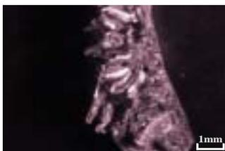
図6-c ドライ加工の切屑(拡大)
